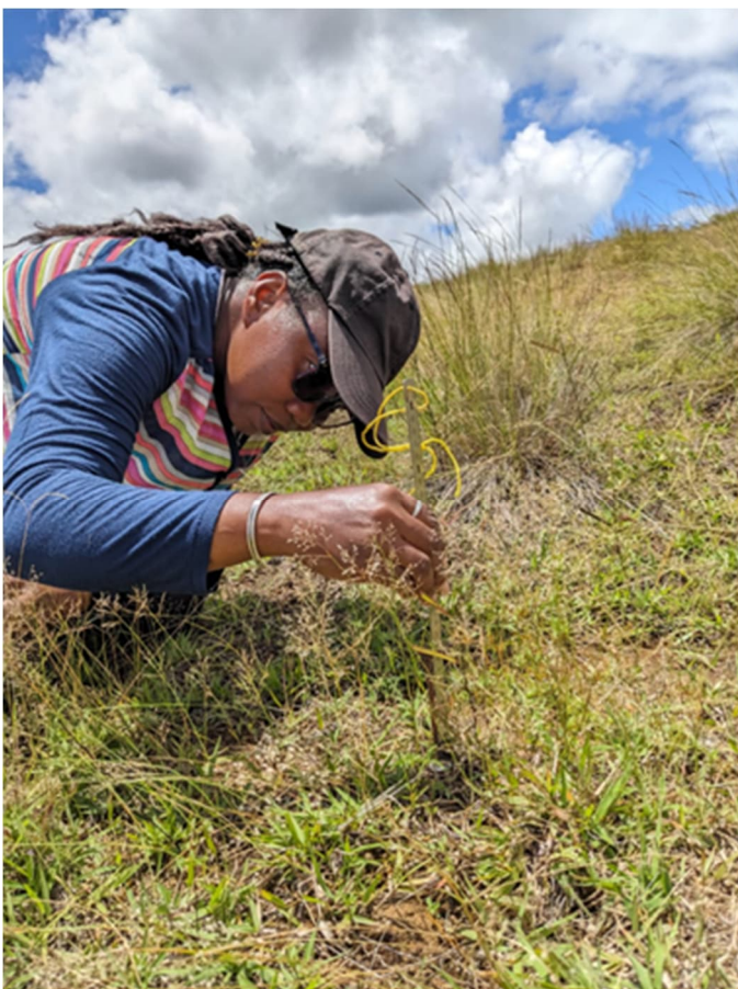
Photo montrant la mesure des piquets du suivi d'érosion
